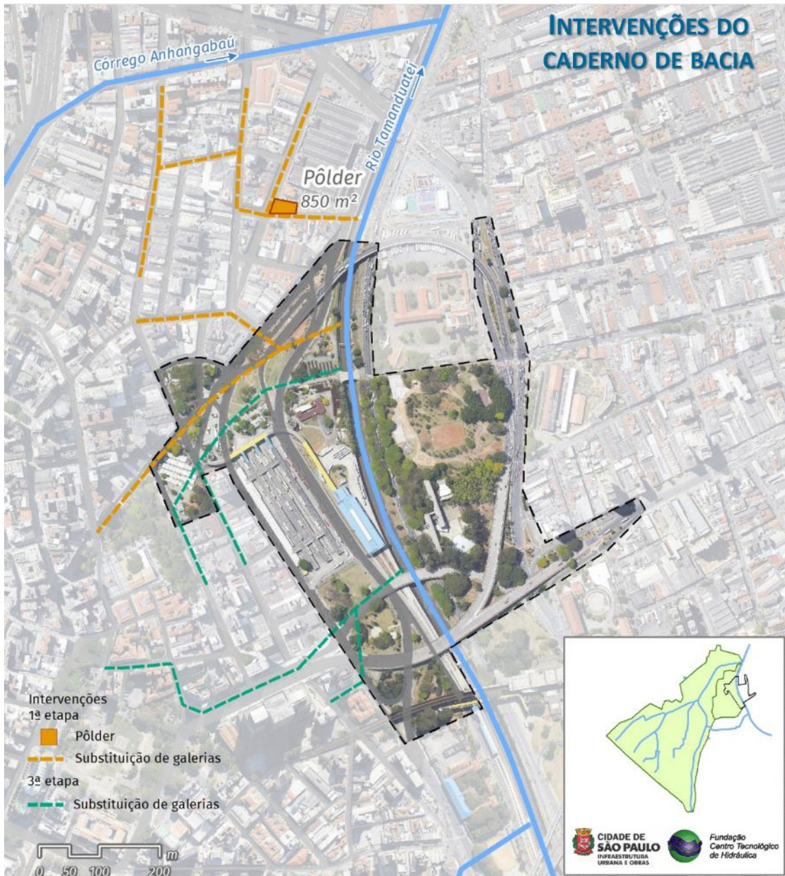
Figura 25 – Mapa com as diretrizes de drenagem para a região do Parque Dom Pedro constantes do Caderno de Bacia Hidrográfica - Bacia do Córrego Anhangabaú (SIURB)
