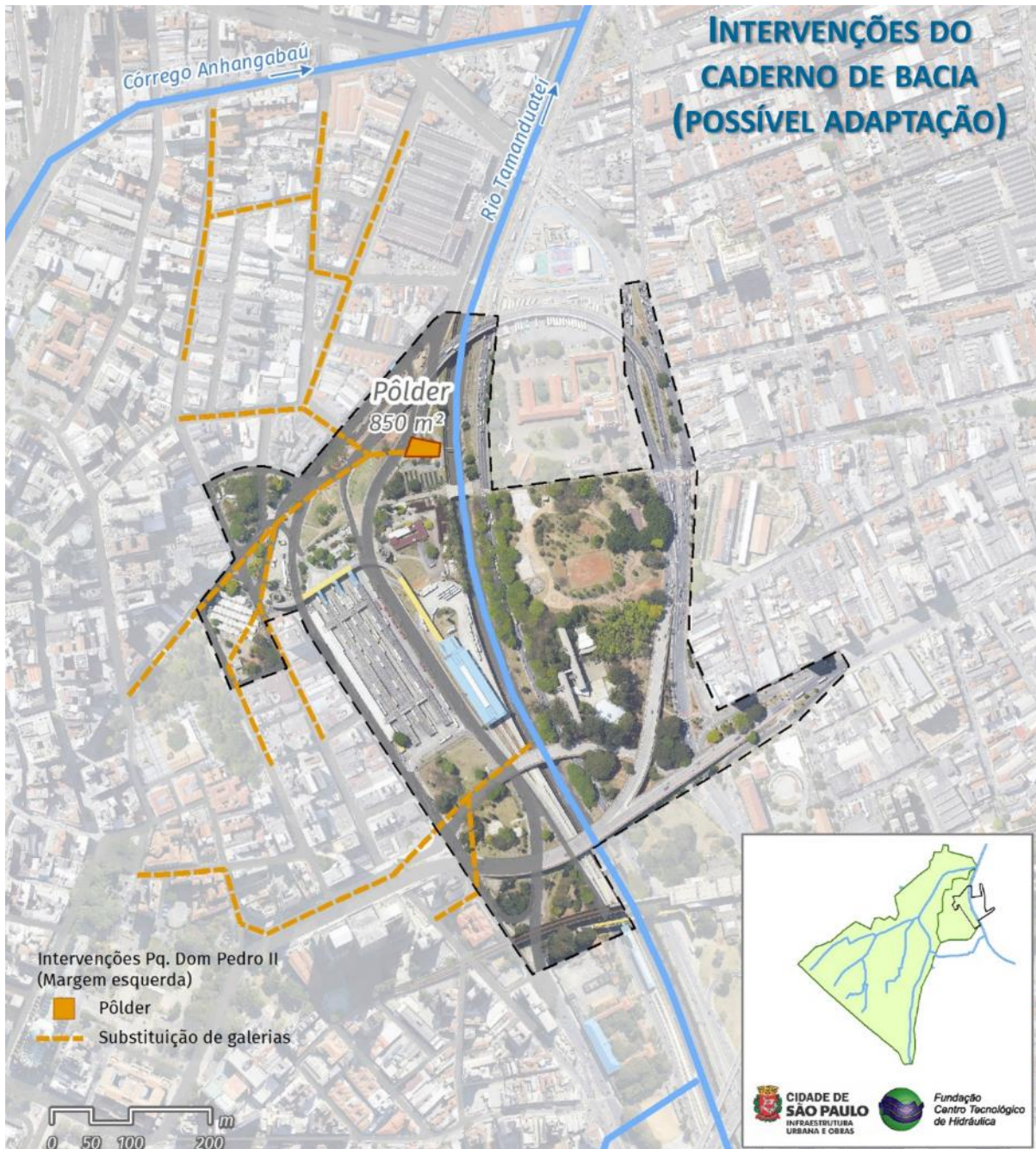
Figura 26 – Mapa com as diretrizes de drenagem adaptadas por SIURB para a região do Parque Dom Pedro para uma das margens do Rio Tamanduaé que deverão ser seguida também para a outra margem do Rio
