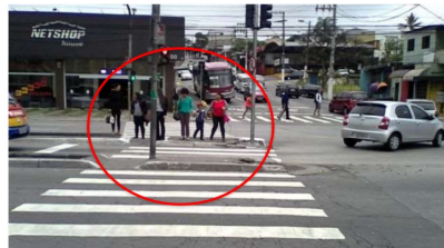
Foto 6- Local com canteiro estreito, conversão à esquerda e travessia em 2 estúgios
