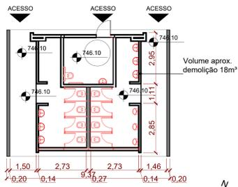
1 Sanitário 04 - Reforma - Planta de Demolição
