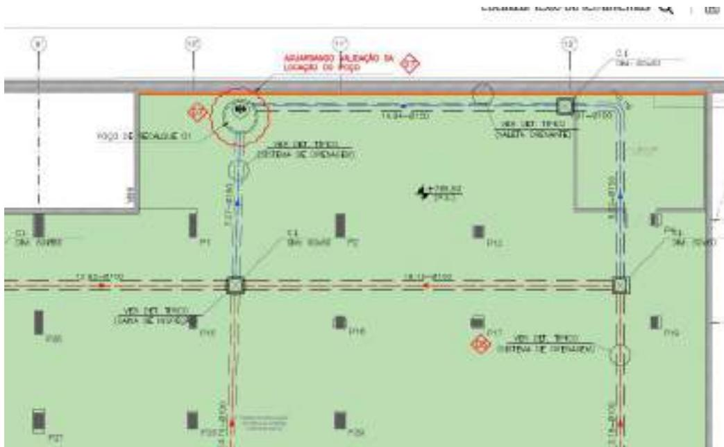
Figura 51 – Poço de recalque da drenagem do 6º subsolo. Fonte: Projeto de Drenagem, 2024.
