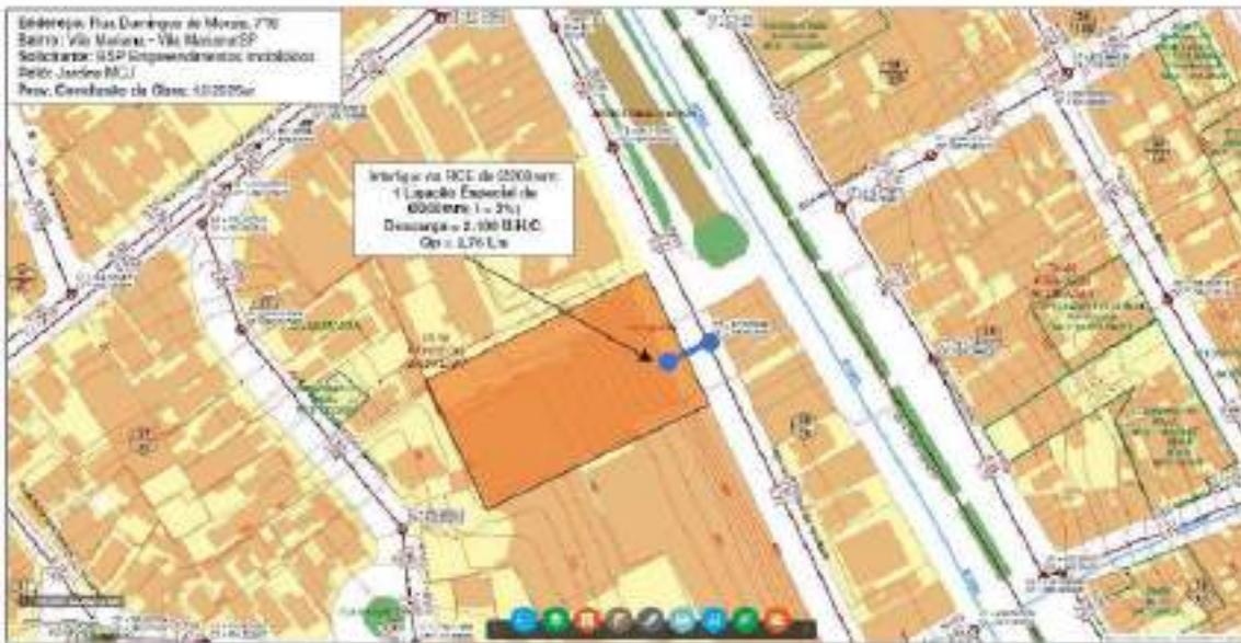
**Figura 53-** - Interligação na rede de esgotos, conforme Diretrizes da Sabesp. Fonte: Sabesp;
