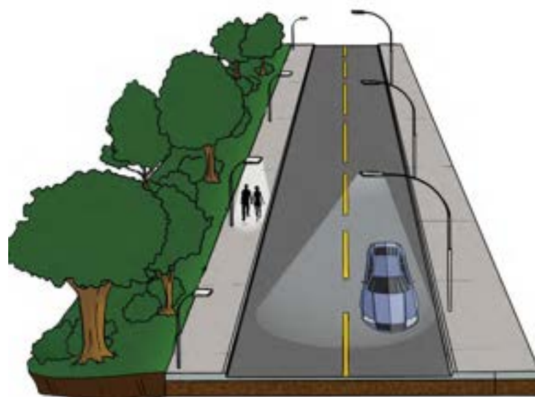
Exemplo de iluminação menos impactante a fauna, com direcionamento focado, altura diferenciada para iluminação de via e iluminação de calçamento.
