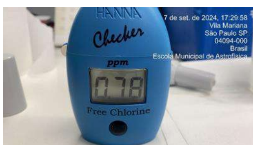
Figura 346: Medição diária de cloro na água da saída do tratamento - Poço artesiano
