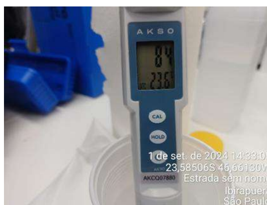
Figura337 : Medição diária de pH na água da saída do tratamento - Poço artesiano
