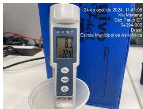
Figura 321: Medição diária de pH na água da saída do tratamento - Poço artesiano
