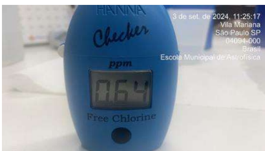
Figura 340: Medição diária de cloro na água da saída do tratamento - Poço artesiano
