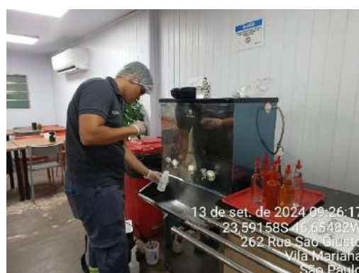
Figura 273.: Coleta de água para análise de potabilidade – Controle Analítico - Bebedouro operacional refeitório interno
