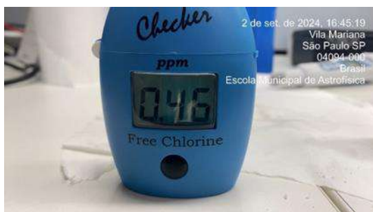
Figura 338: Medição diária de cloro na água da saída do tratamento - Poço artesiano
