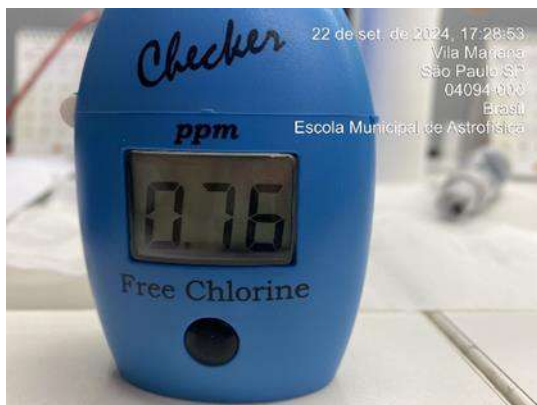
Figura 368: Medição diária de cloro na água da saída do tratamento - Poço artesiano
