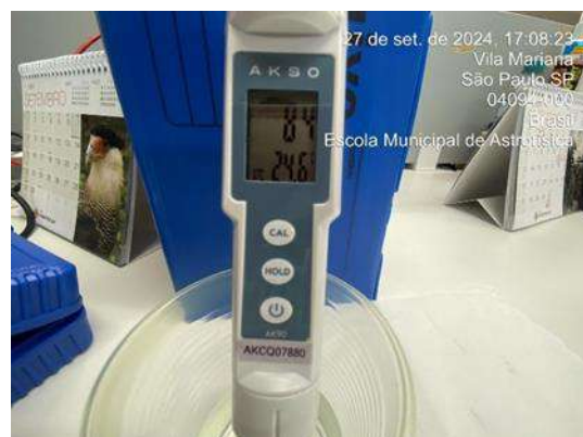
Figura377 : Medição diária de pH na água da saída do tratamento - Poço artesiano
