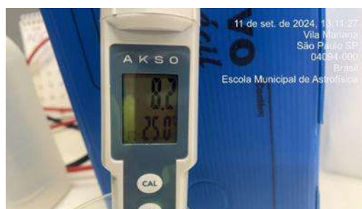
Figura 353: Medição diária de pH na água da saída do tratamento - Poço artesiano
