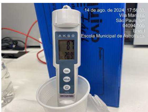
Figura304 : Medição diária de pH na água da saída do tratamento - Poço artesiano
