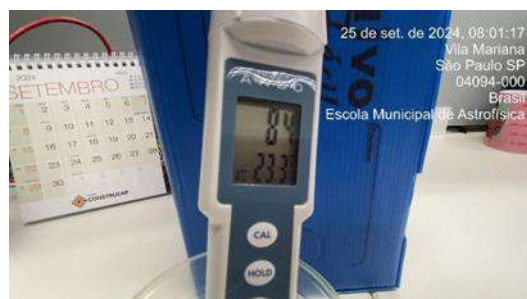
Figura 371: Medição diária de pH na água da saída do tratamento - Poço artesiano - referente a coleta do dia 24/09/2024
