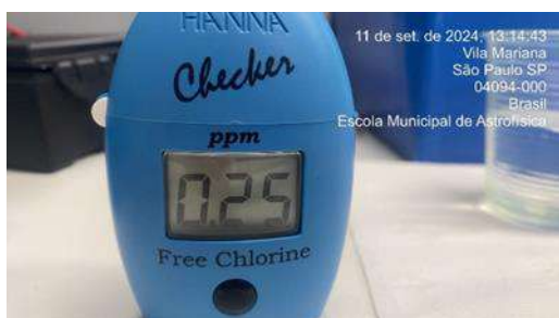
Figura 352: Medição diária de cloro na água da saída do tratamento - Poço artesiano
