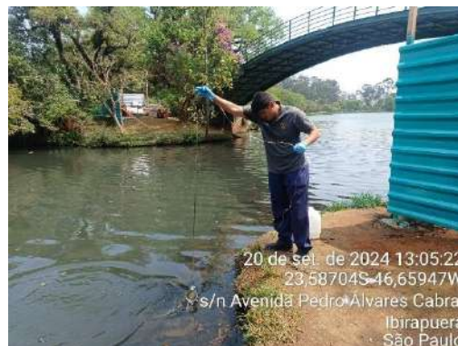
Figura 287.: Coleta de água para análise de Conama e efluentes – Controle Analítico - Córrego do Sapateiro
