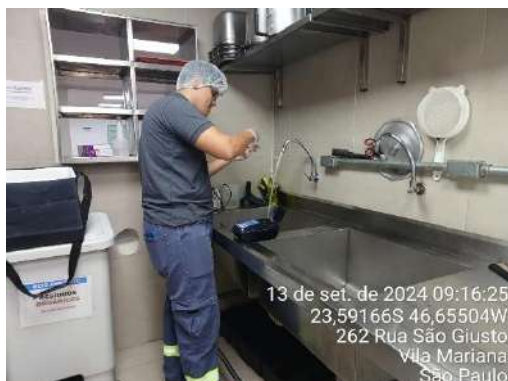
Figura274.: Coleta de água para análise de potabilidade – Controle Analítico - Torneira copa refeitório operacional
