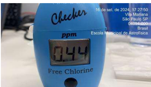
Figura 358: Medição diária de cloro na água da saída do tratamento - Poço artesiano
