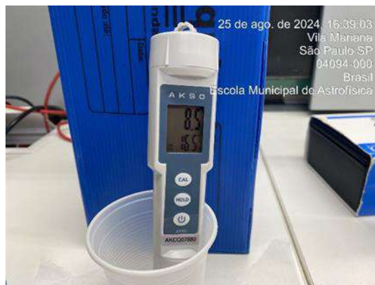
Figura 323: Medição diária de pH na água da saída do tratamento - Poço artesiano
