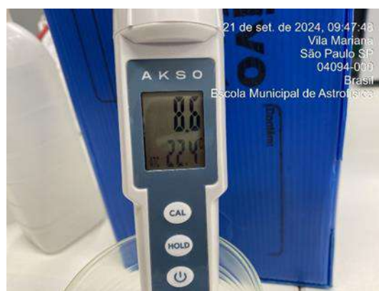
Figura 365: Medição diária de pH na água da saída do tratamento - Poço artesiano
