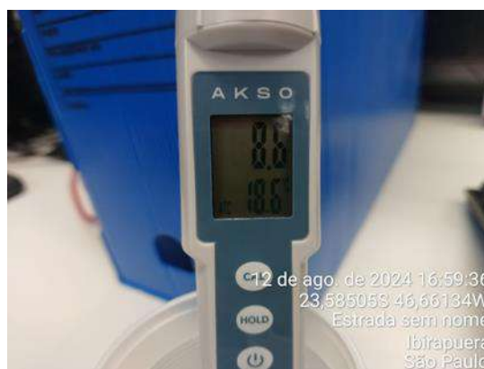
Figura301 : Medição diária de pH na água da saída do tratamento - Poço artesiano
