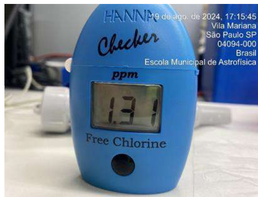
Figura 313: Medição diária de cloro na água da saída do tratamento - Poço artesiano
