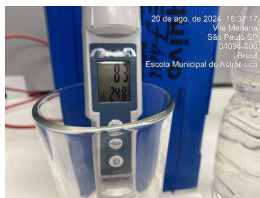
Figura315 : Medição diária de pH na água da saída do tratamento - Poço artesiano
