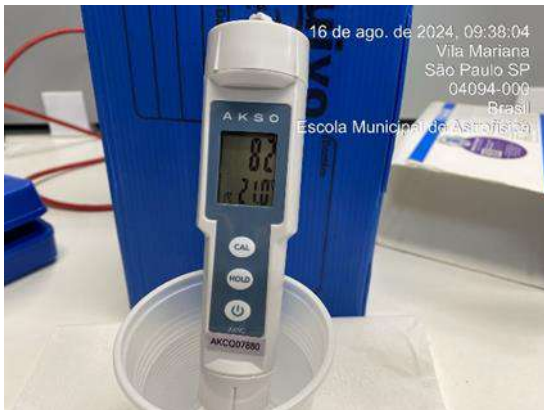
Figura 308: Medição diária de pH na água da saída do tratamento - Poço artesiano
