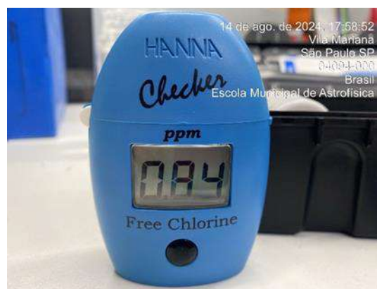
Figura305 : Medição diária de cloro na água da saída do tratamento - Poço artesiano
