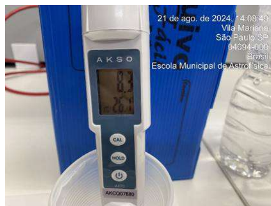
Figura317 : Medição diária de pH na água da saída do tratamento - Poço artesiano
