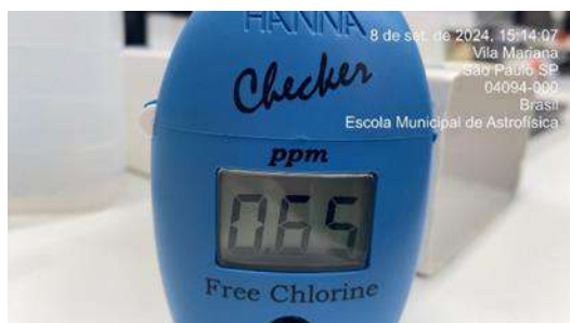
Figura 348: Medição diária de cloro na água da saída do tratamento - Poço artesiano
