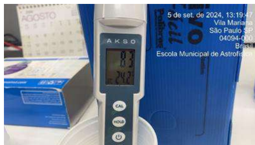
Figura 347: Medição diária de pH na água da saída do tratamento - Poço artesiano
