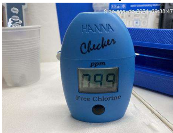
Figura 296: Medição diária de cloro na água da saída do tratamento - Poço artesiano
