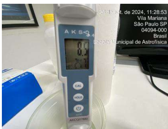
Figura 375: Medição diária de pH na água da saída do tratamento - Poço artesiano
