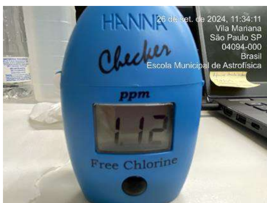
Figura 374 : Medição diária de cloro na água da saída do tratamento - Poço artesiano
