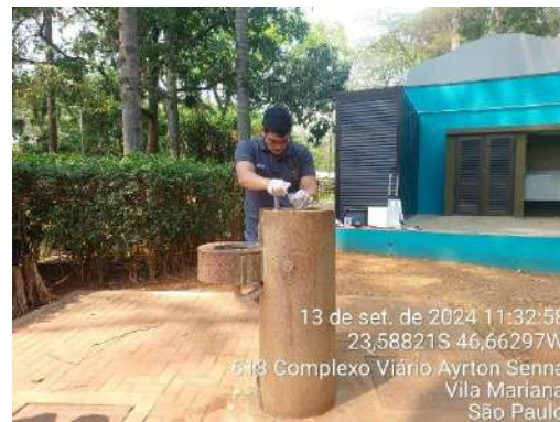
Figura 261.: Coleta de água para análise de potabilidade – Controle Analítico - Bebedouro publico banheiro 6
