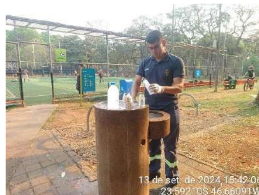
Figura 263.: Coleta de água para análise de potabilidade – Controle Analítico - Bebedouro publico campo society
