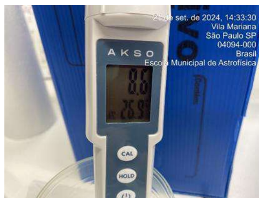
Figura 367: Medição diária de pH na água da saída do tratamento - Poço artesiano
