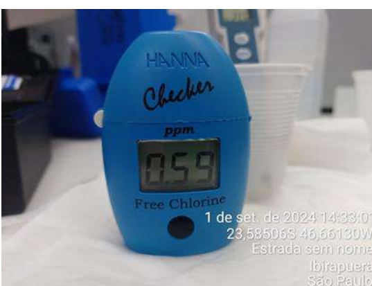
Figura336 : Medição diária de cloro na água da saída do tratamento - Poço artesiano
