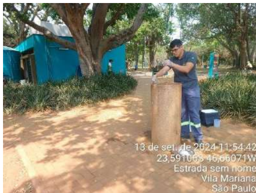
Figura 260.: Coleta de água para análise de potabilidade – Controle Analítico - Bebedouro público banheiro 5
