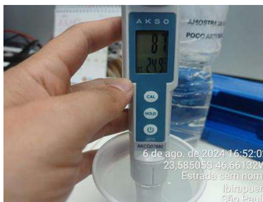
Figura291 : Medição diária de pH na água da saída do tratamento - Poço artesiano
