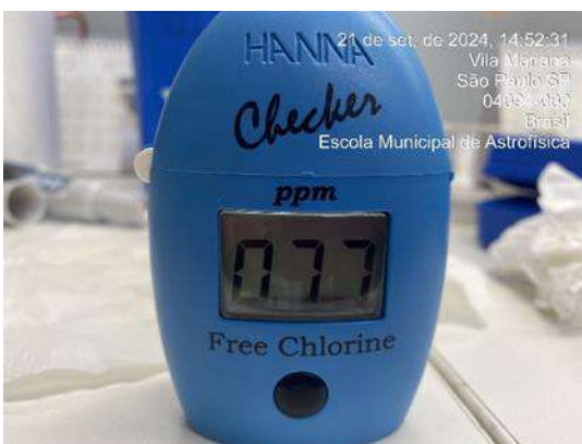
Figura 366: Medição diária de cloro na água da saída do tratamento - Poço artesiano
