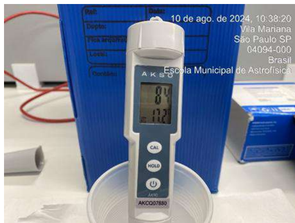
Figura301 : Medição diária de pH na água da saída do tratamento - Poço artesiano
