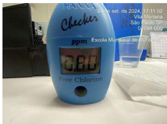
Figura376 : Medição diária de cloro na água da saída do tratamento - Poço artesiano
