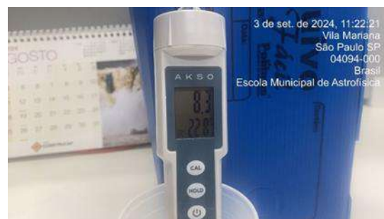
Figura 341: Medição diária de pH na água da saída do tratamento - Poço artesiano
