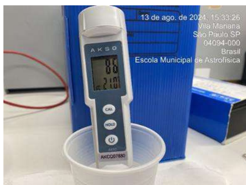
Figura 302: Medição diária de pH na água da saída do tratamento - Poço artesiano
