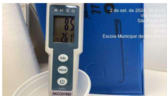
Figura 339: Medição diária de pH na água da saída do tratamento - Poço artesiano
