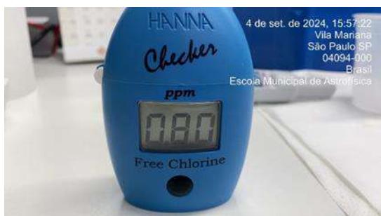
Figura 342: Medição diária de cloro na água da saída do tratamento - Poço artesiano
