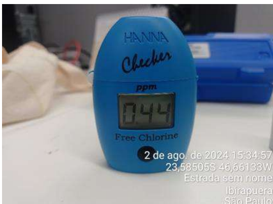
Figura 290: Medição diária de cloro na água da saída do tratamento - Poço artesiano
