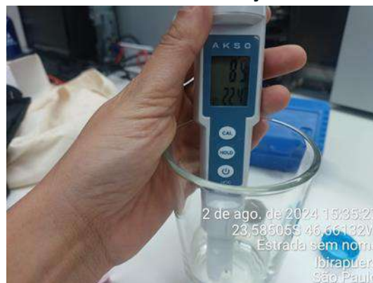
Figura 289: Medição diária de pH na água da saída do tratamento - Poço artesiano
