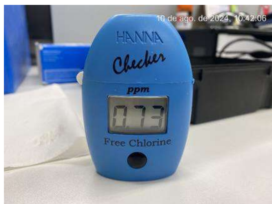
Figura 298: Medição diária de cloro na água da saída do tratamento - Poço artesiano
