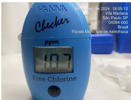
Figura 330: Medição diária de cloro na água da saída do tratamento - Poço artesiano
