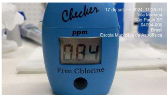
Figura 360: Medição diária de cloro na água da saída do tratamento - Poço artesiano
