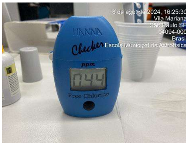
Figura 294: Medição diária de cloro na água da saída do tratamento - Poço artesiano
