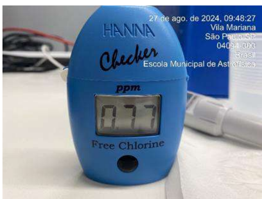
Figura326 : Medição diária de cloro na água da saída do tratamento - Poço artesiano
