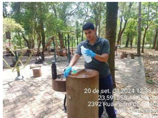
Figura 281.: Coleta de água para análise de potabilidade – Controle Analítico -Bebedouro público academia flintstones
