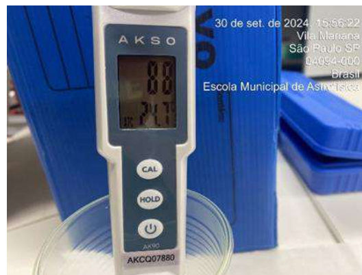
Figura 379: Medição diária de pH na água da saída do tratamento - Poço artesiano
