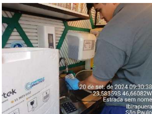
Figura 278.: Coleta de água para análise de potabilidade – Controle Analítico - Toneira restaurante Sabiá
