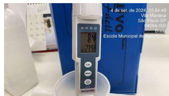
Figura 343: Medição diária de pH na água da saída do tratamento - Poço artesiano
