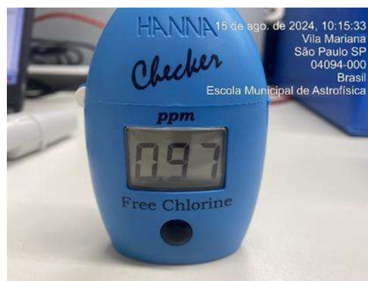
Figura 307: Medição diária de cloro na água da saída do tratamento - Poço artesiano
