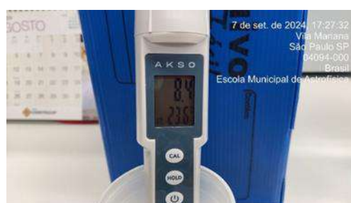
Figura 347: Medição diária de pH na água da saída do tratamento - Poço artesiano
