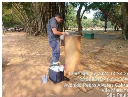
Figura 271.: Coleta de água para análise de potabilidade – Controle Analítico - Torneira copa Ema
