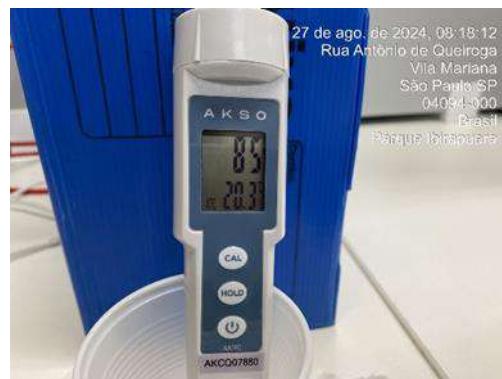
Figura 325: Medição diária de pH na água da saída do tratamento - Poço artesiano - referente a água coletada no dia 26/08
