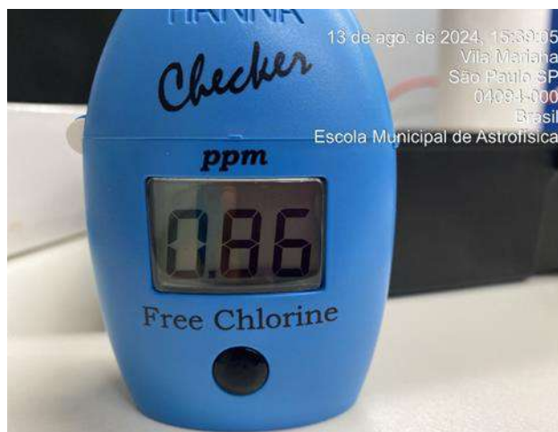
Figura305 : Medição diária de cloro na água da saída do tratamento - Poço artesiano
