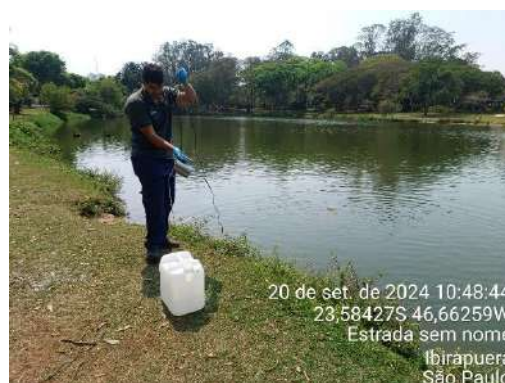
Figura 285.: Coleta de água para análise de Conama e efluentes – Controle Analítico - Lago 2 das Garsas
