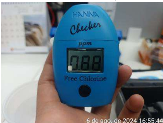
Figura 290: Medição diária de cloro na água da saída do tratamento - Poço artesiano
