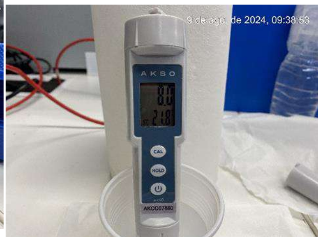
Figura 297: Medição diária de pH na água da saída do tratamento - Poço artesiano
