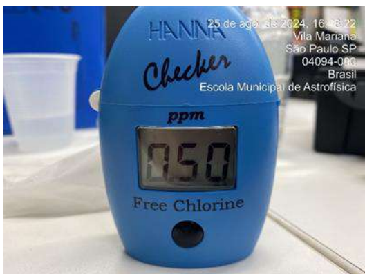
Figura 322: Medição diária de cloro na água da saída do tratamento - Poço artesiano
