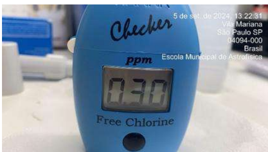
Figura 346: Medição diária de cloro na água da saída do tratamento - Poço artesiano
