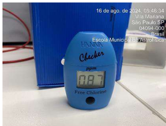
Figura 309: Medição diária de cloro na água da saída do tratamento - Poço artesiano
