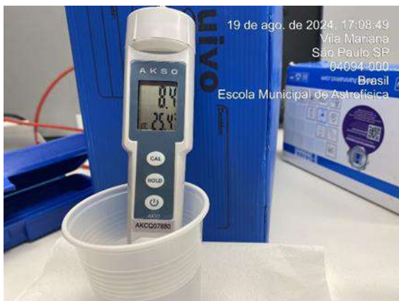
Figura312 : Medição diária de pH na água da saída do tratamento - Poço artesiano
