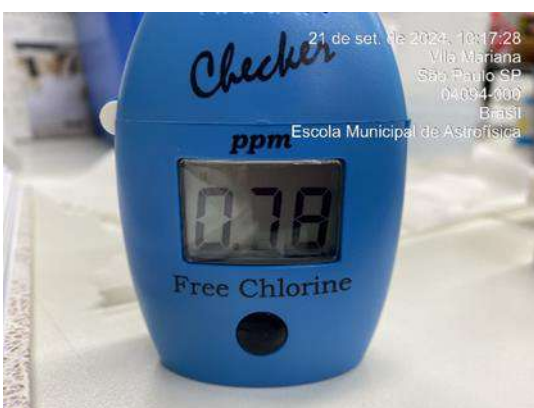
Figura 364: Medição diária de cloro na água da saída do tratamento - Poço artesiano
