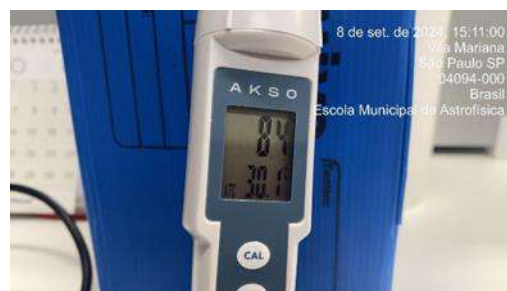
Figura 349: Medição diária de pH na água da saída do tratamento - Poço artesiano
