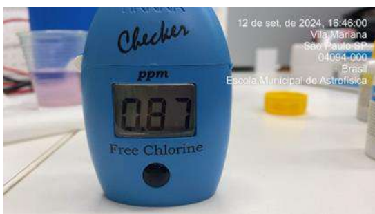
Figura 354: Medição diária de cloro na água da saída do tratamento - Poço artesiano
