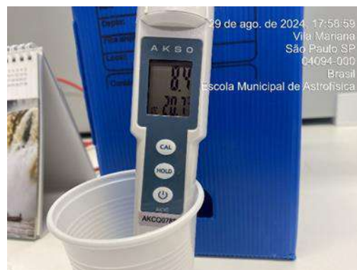
Figura 331: Medição diária de pH na água da saída do tratamento - Poço artesiano
