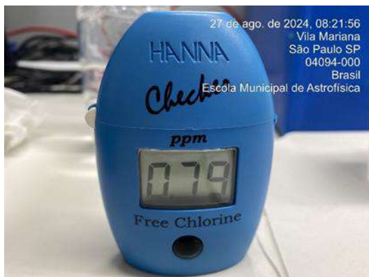
Figura324 : Medição diária de cloro na água da saída do tratamento - Poço artesiano - referente a água coletada no dia 26/08
