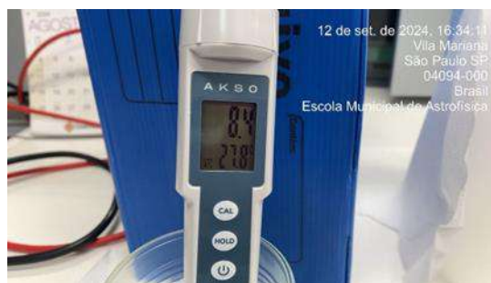
Figura 355: Medição diária de pH na água da saída do tratamento - Poço artesiano
