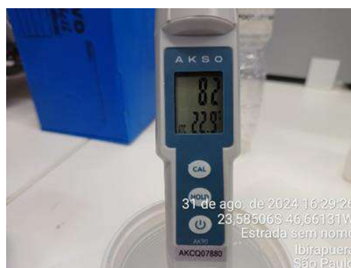
Figura 335: Medição diária de pH na água da saída do tratamento - Poço artesiano
