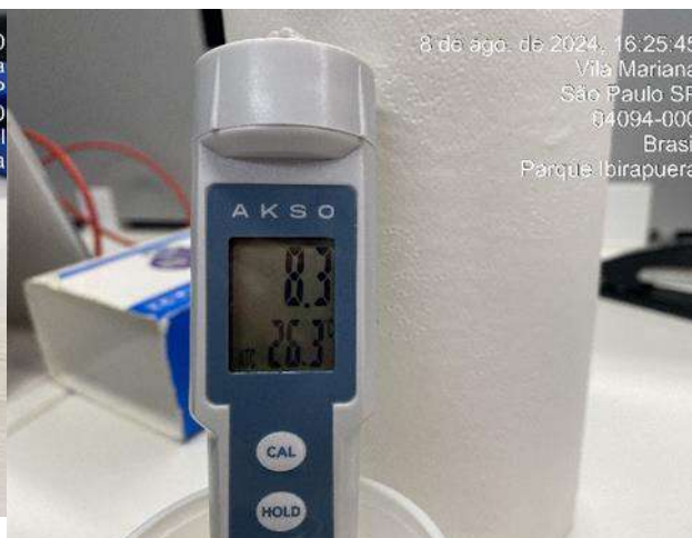
Figura 297: Medição diária de pH na água da saída do tratamento - Poço artesiano
