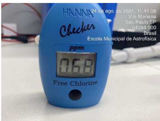
Figura 320: Medição diária de cloro na água da saída do tratamento - Poço artesiano
