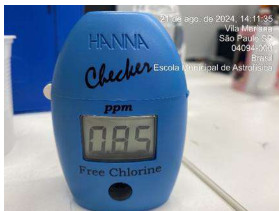
Figura316 : Medição diária de cloro na água da saída do tratamento - Poço artesiano
