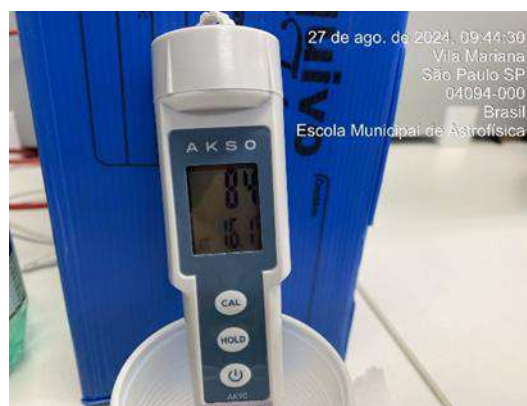
Figura327 : Medição diária de pH na água da saída do tratamento - Poço artesiano
