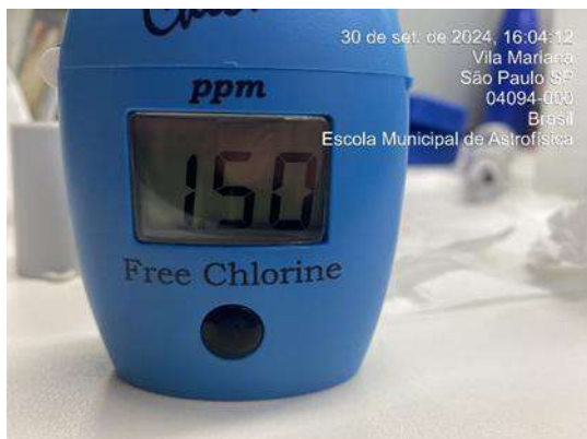
Figura378 : Medição diária de cloro na água da saída do tratamento - Poço artesiano
