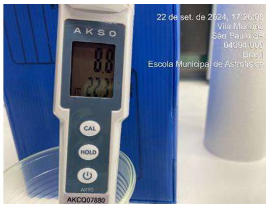
Figura 369: Medição diária de pH na água da saída do tratamento - Poço artesiano
