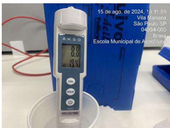
Figura 306: Medição diária de pH na água da saída do tratamento - Poço artesiano
