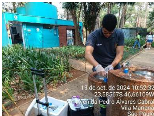
Figura 262.: Coleta de água para análise de potabilidade – Controle Analítico - Bebedouro publico banheiro 7
