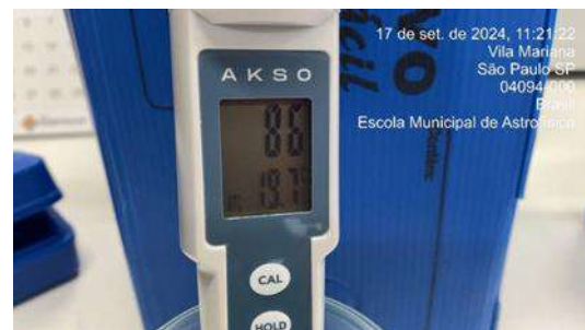
Figura361 : Medição diária de pH na água da saída do tratamento - Poço artesiano
