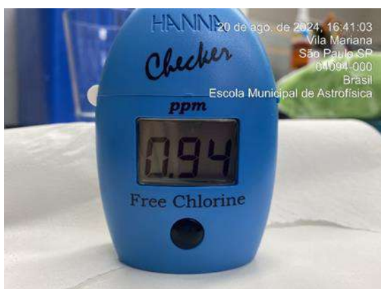
Figura314 : Medição diária de cloro na água da saída do tratamento - Poço artesiano
