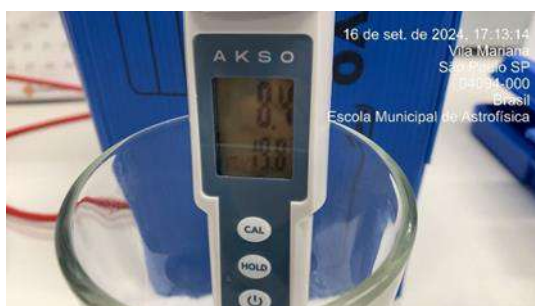
Figura359 : Medição diária de pH na água da saída do tratamento - Poço artesiano
