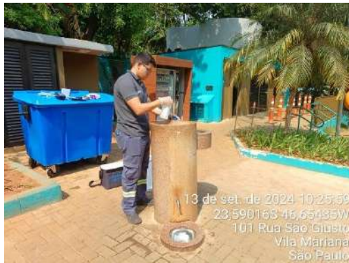
Figura 260.: Coleta de água para análise de potabilidade – Controle Analítico - Bebedouro público banheiro 5
