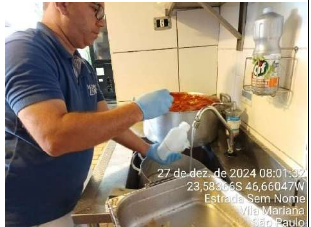
Figura 222 Coleta de água para análise de potabilidade – Hidrolabor - Torneira copa Restaurante Sabiá - Parque Ibirapuera
