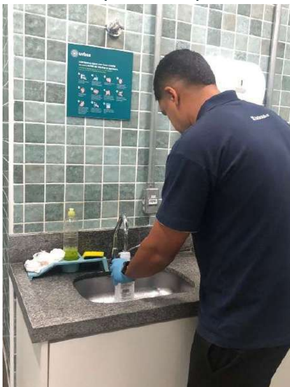
Figura 217 Coleta de água para análise de potabilidade - Hidrolabor - Torneira copa Parque dos Eucalipto
