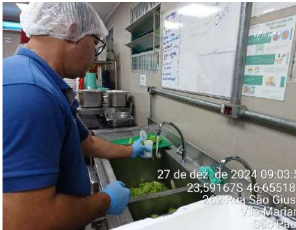
Figura 227 Coleta de água para análise de potabilidade – Hidrolabor - Torneira Refeitório operacional - Parque Ibirapuera
