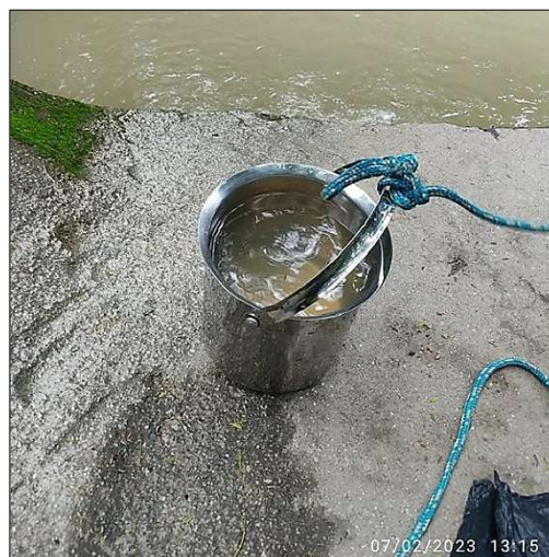
b) Balde de inox, esterilizado, para coleta em locais de difícil acesso.
