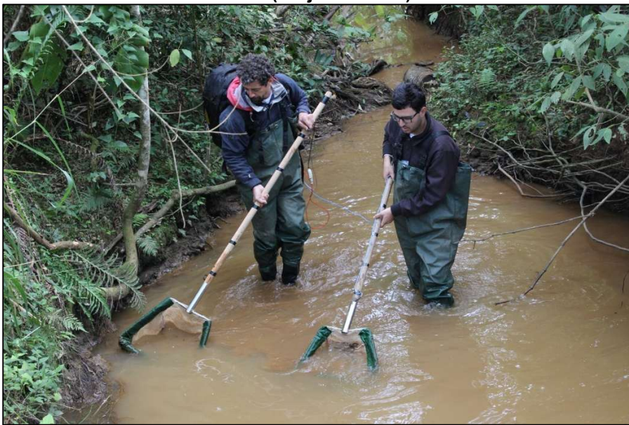
Figura I: 16 - Amostragem com a metodologia de pesca elétrica no ponto BA07 (C2-junho/2023).
