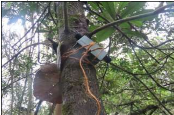
Figura I: 12 - Gravador bioacústico automático para amostragem de anurofauna.
