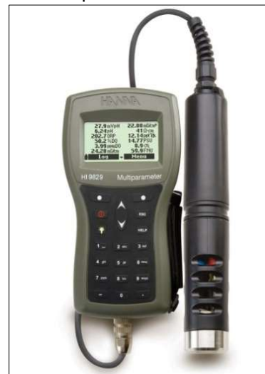
Figura I: 2 – Sonda multiparâmetro de registro portátil, marca Hanna, utilizada para análise in situ na área do RVS Anhanguera.
