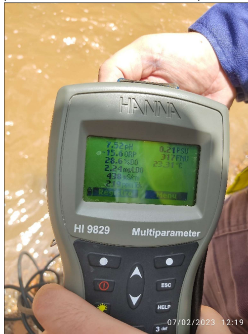
d) Detalhe do leitor da sonda multiparâmetro.
