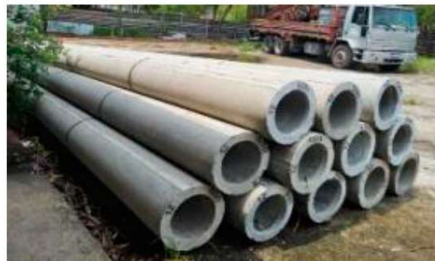
6 – Postes de concreto para rede elétrica.
