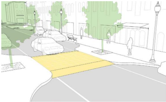
Plataformas atenuadoras de velocidade
